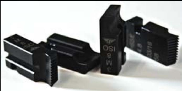
Die Gewindeschneidbacken werden aus bestem Hochleistungs-Schnellarbeitsstahl hergestellt. Die eigentliche Schnittleistung der Gewindeschneidbacken hat der Anschnitt zu verrichten, die nachfolgenden Gewindegänge dienen als Führung.
